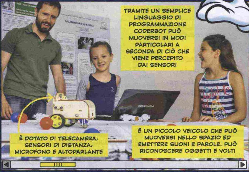
**TRAMITE UN SEMPLICE LINGUAGGIO DI PROGRAMMAZIONE CODERBOT PUÒ MUOVERSI IN MODI PARTICOLARI A SECONDA DI CIÒ CHE VIENE PERCEPITO DAI SENSORI**
